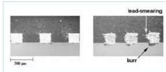
図1：切断品質の変動を示すダイシングされた QFN サンプルの断面の顕微鏡写真。
